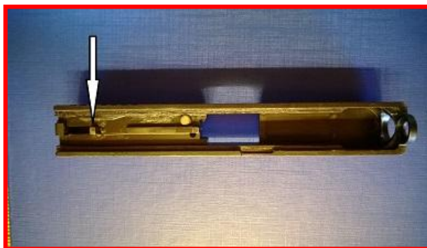
Il percussore di una safe-action
