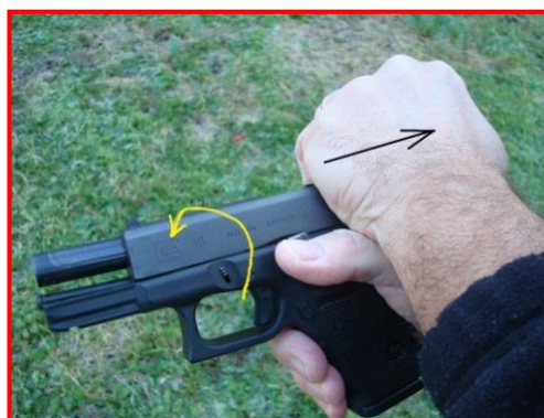
Arretrare il carrello otturatore e bloccarlo aperto con leva blocco/sblocco carrello
