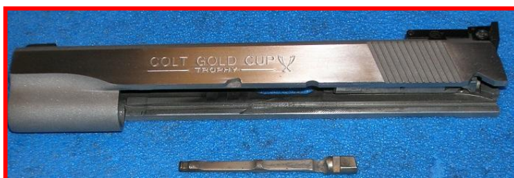
L'unghia estrattrice interna ed il carrello otturatore di una Colt 1911
