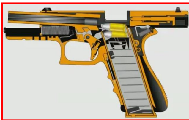
Il ricaricamento della nuova munizione in un'arma semiautomatica.
