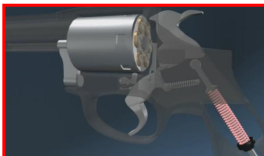
Il meccanismo di sgancio del cane
