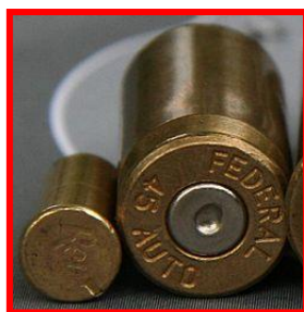
Comparazione fra il bossolo di una munizione rimfire in calibro .22Lr, a sinistra ed il bossolo di una munizione centerfire in calibro .45ACP a destra. Si noti l'impronta del percussore centralmente posizionata sul bossolo centerfire.
