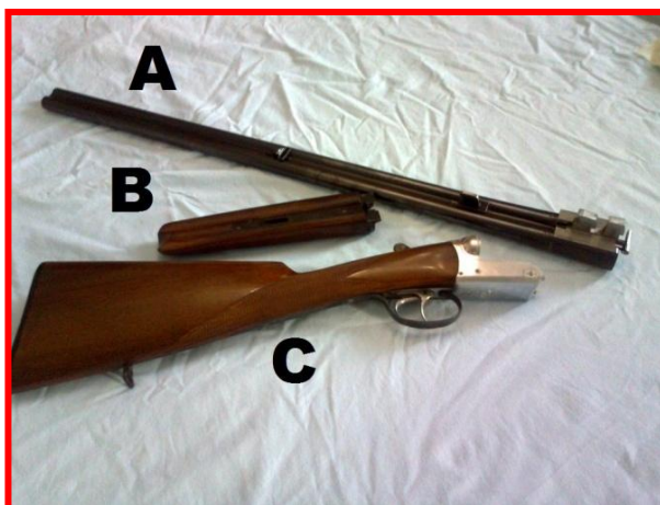
Doppietta smontata: a) Canne; b) Astina; c) Bascula con calcio
